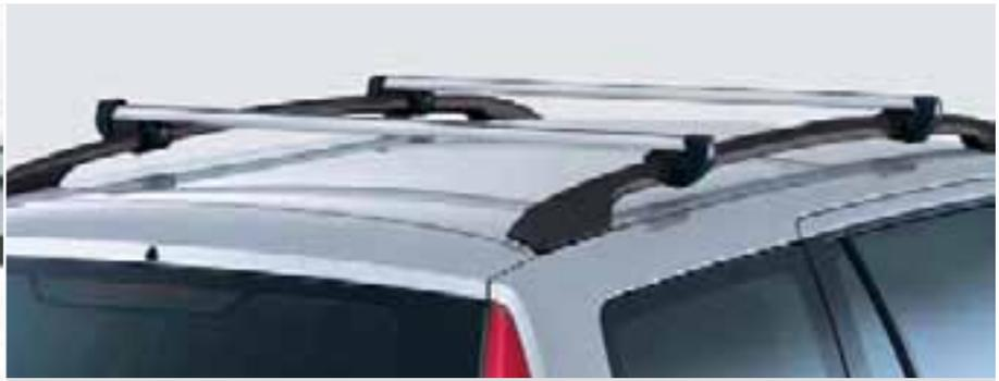
Barre trasversali in alluminio per barre longitudinali, con serratura
